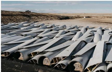
En la actualidad, las palas están fabricadas mediante un proceso artesanal a base de fibra de vidrio que es endurecida con resinas con el fin de que sean duraderas e indeformables. En consecuencia, debido a su los materiales empleados, diseño y estructura, una vez que **las aspas** quedan obsoletas, se convierten en **elementos escasamente reutilizados y difícilmente degradables** (si no es por procedimientos específicos, difíciles y costosos).
