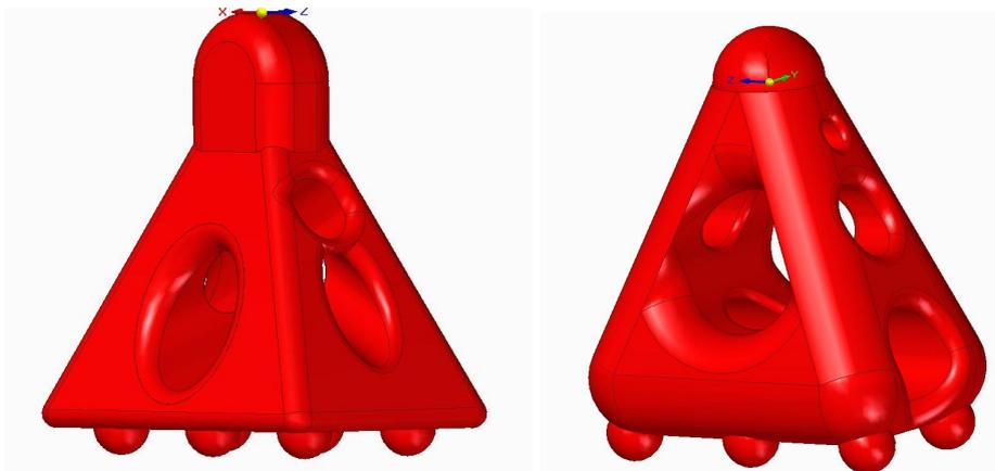
En la tercera fase de diseño de nuestro prototipo se sustituyó el diseño de la parte inferior de los prototipos para su mejor sujeción manual , aportando de esta forma la posibilidad de utilizarlo manualmente sin necesidad de apoyarlo en una superficie.
