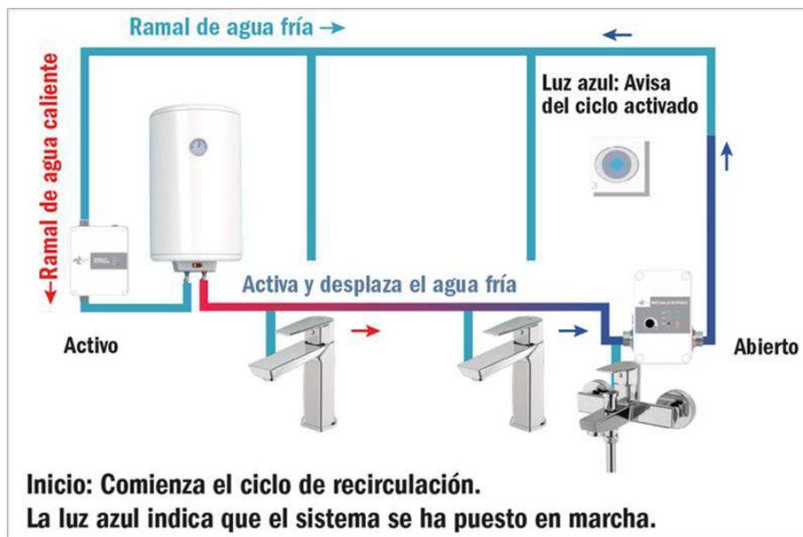
Como se muestra en la imagen al ponerse en marcha el agua a la temperatura deseada empieza la recirculación del agua fría por la instalación con ayuda de un sistema de bombas hasta que la válvula detecta la temperatura deseada. Es muy importante en la instalación el sistema de electroválvulas con sensores térmicos y equipo de bombear de nuevo el agua a la presión deseada a la caldera nuevamente.
