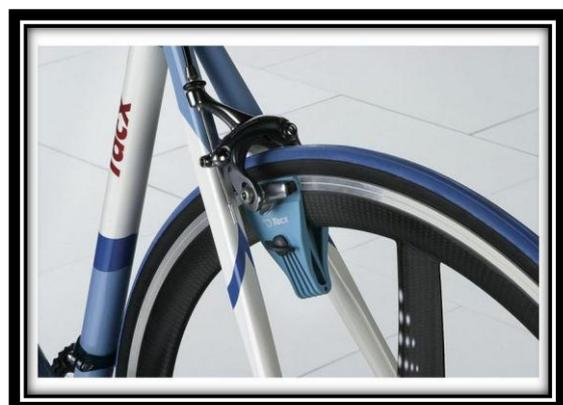
Imagen 2. Frenos de zapata.
