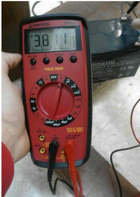
Aquí aparece un polímetro que indica la cantidad de voltaje que contiene almacenada la batería una vez conectado al panel solar
