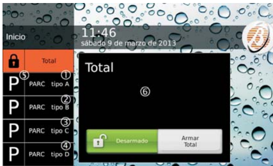
Figura 24 Inserción con teclado Touch: Las etiquetas 1, 2, 3 y 4 pueden personalizarse como explicado en el texto, en la posición 5 se colocará la letra inicial de la inserción Especial correspondiente; en la ventana 6 aparecerá la descripción asignada a la inserción seleccionada como se explica en el texto.
